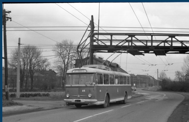
Trolejbus 9 Tr pod ochrannou konstrukcí důlní lanové dráhy na Michálkovičské ulici
