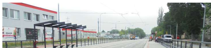
V prostoru zastávky Rodimcevova došlo k rozšíření osové vzdálenosti kolejí z 3,1 m na 3,5 m, a to pro možnost míjení autobusů v zastávce
