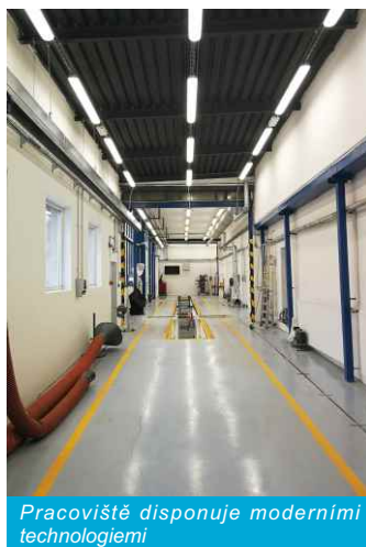
Novou jámu podařilo se prodloužit na délku článkového autobusu
