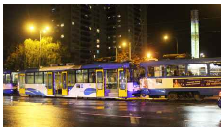
Dopravní nehoda ze dne 29. 10. 2020, křižovatka ulic Opavská x Martinovská, kdy řidička tramvaje kurzu 9/402 na lince 7 přehlédla postavení výhybky, narazila do protijedoucího kurzu 7/276 a došlo ke střetu se zraněním 10 osob, včetně obou řidičů, odhadnutá škoda celkem přes 3 mil. Kč
