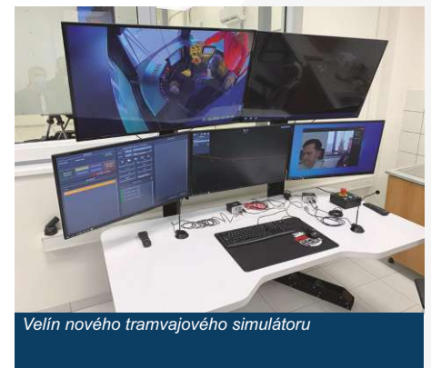
Simulátor pracuje s vizualizací ostravské tramvajové sítě pořízené z videozáznamu kamery umístěné na čele jedné z našich tramvají
