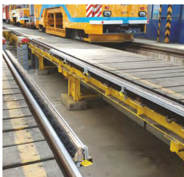
Pohled na kartáče, které slouží k čištění tramvajových kol
